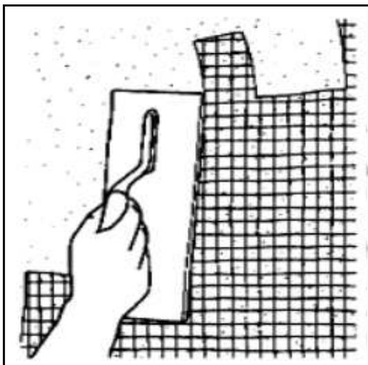
Armacolle est une pâte en phase aqueuse pour l'entoilage du polystyrène expansé pour l'isolation par l'extérieur.
