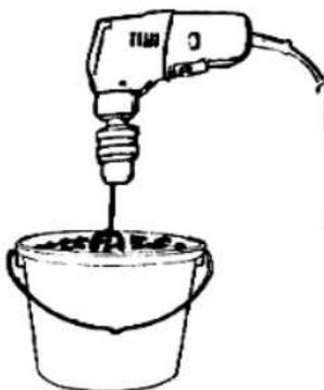
**Isocolle** vorbereiten durch Beimengen von 20 bis 25 % Zement CEM II. Hierzu einfach den Eimer bis zur Strichmarke auf dem Etikett auffüllen.
