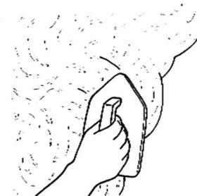
**Nach dem Trocknen** Deckputz **Résicolor** oder **Résigrain** in gewünschtem Farbton, Korngröße und Struktur auftragen.
